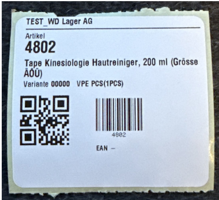
Abb. 24: Ausdruck muster_item_4802.zpl am ZD410 (Foto, 57 × 51 mm): Umlaute korrekt, QR und Code 128 mit Artikelnummer, EAN leer
